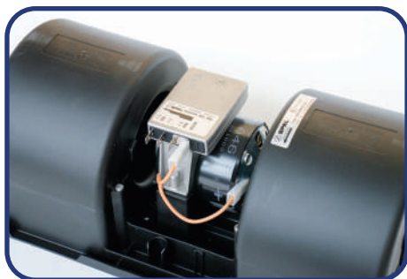
RA = resistore ad alta temperatura sul motore
